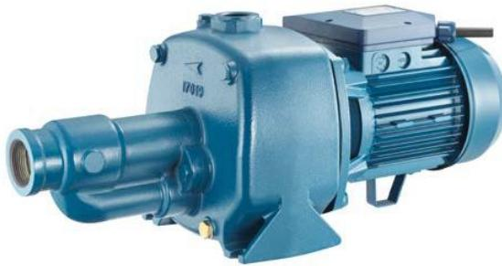
Pompa auto-adescante di tipo centrifugo adatta per approvvigionamento d'acqua (anche se miscelata a gas) in piccoli e medi impianti domestici e civili; quando accoppiate a serbatoi autoclave, costituiscono un sistema di pressurizzazione automatico.
